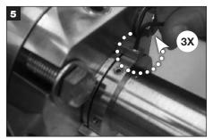
Die Innensechskantschrauben lockern und die 3 Zentrierklammern entfernen; die Schrauben und Zentrierklammern zur zukünftigen Einstellung des Laufrads oder zur erneuten Montage der Dichtung aufbewahren.
