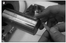
Eine dünne Fettschicht auf den Wellendurchmesser auftragen.
