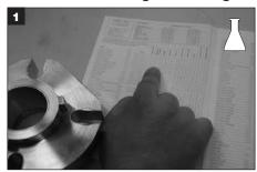
Die Chemikalienlisten nachprüfen, um sicherzustellen, dass die eingebauten O-Ringe mit den abgedichteten Flüssigkeiten verträglich sind.
